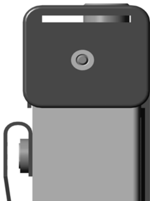
Рис.4. Расположение гайки, закрывающей доступ к регулировочным потенциометрам
