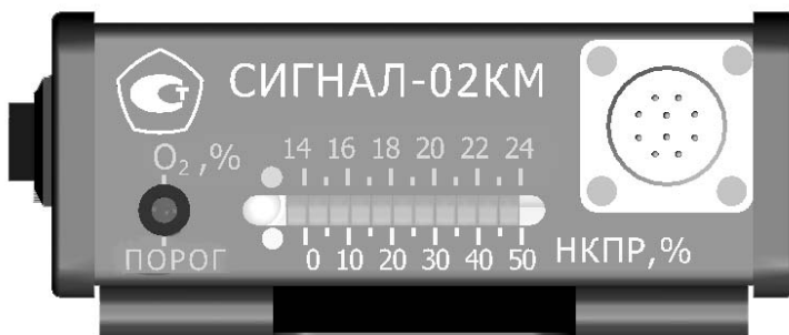
Рис. 3. Внешний вид передней панели сигнализатора
