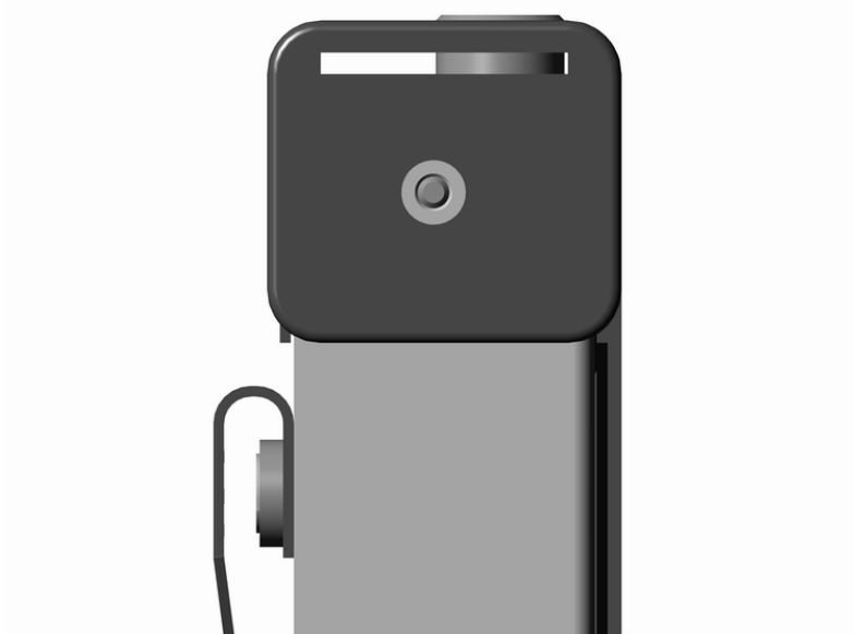
Рис.4. Расположение винта, закрывающего доступ к регулировочным потенциометрам.
