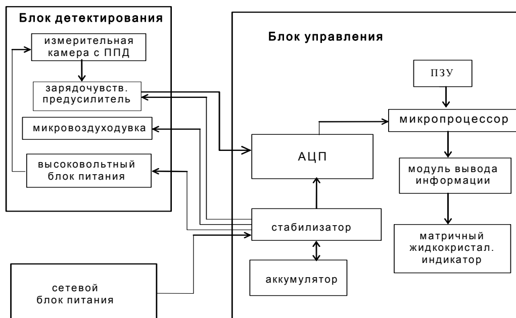
Рисунок 3. Функциональная схема радиометра.
