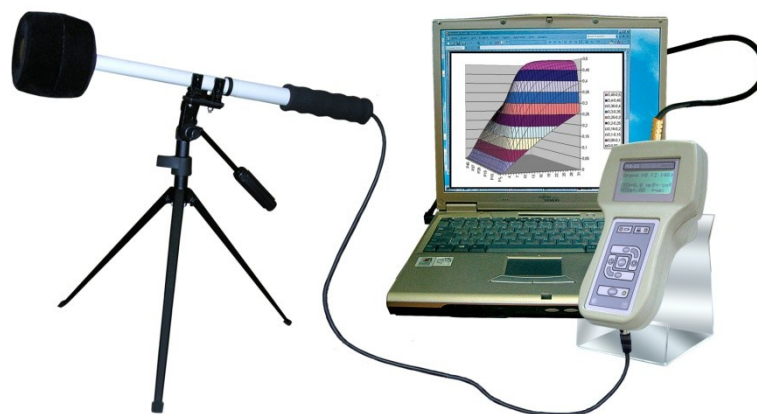
Рисунок 2. Внешний вид измерителя с антенной и компьютером для приема результатов измерений.
