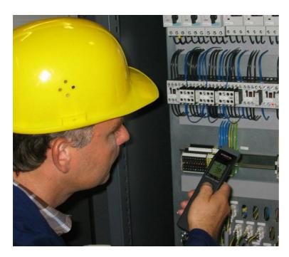
Широкий температурный диапазон от -32 до 530°C, лазерное нацеливание и высокое оптическое разрешение 20:1 позволяют использовать прибор как средство обнаружения неисправностей и диагностики проблем электрического, механического оборудования, диагностики вентиляции систем кондиционирования других приложений, где контролировать температуру необходимо.
