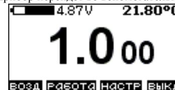
7.2. В верхней строчке отображается напряжение питающей батареи - рядом со стилистическим изображением гальванического элемента и температура среды в которой находится датчик. В центре экрана крупными цифрами - диэлектрическая проницаемость среды. В нижней строчке - назначение кнопок - над каждой из них.
