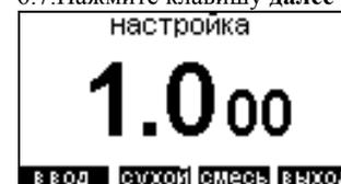
здесь крупные цифры обозначают диэлектрическую проницаемость среды.
