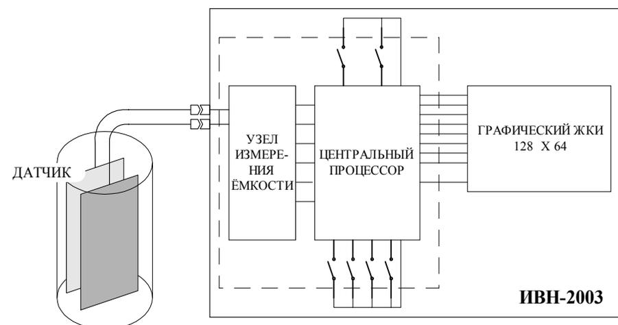
4.3. Функционально прибор состоит из блока электронного и преобразователя емкостного, соединённых двойным коаксиальным кабелем.
