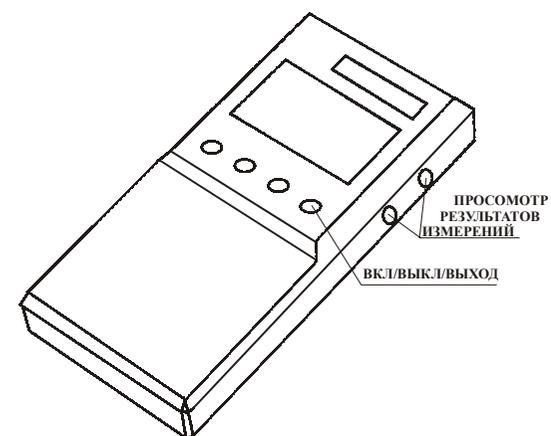
Поскольку количество клавиш невелико, каждая из них выполняет несколько функций, в зависимости от режима, в котором находится прибор. Функция, выполняемая каждой клавишей, расположенной на передней панели прибора, указывается надписью над этой клавишей.
