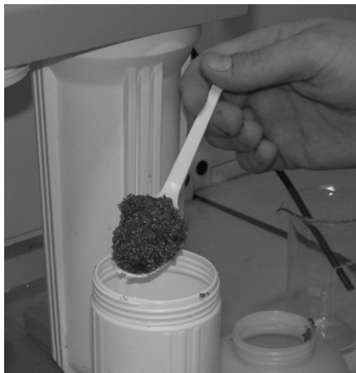
Рис. 5. Заполнение кассеты смолой
