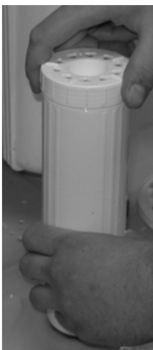
Рис. 4. Разборка кассеты со смолой
