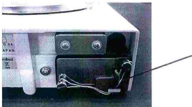
Рисунок 2 – Схема пломбировки весов
