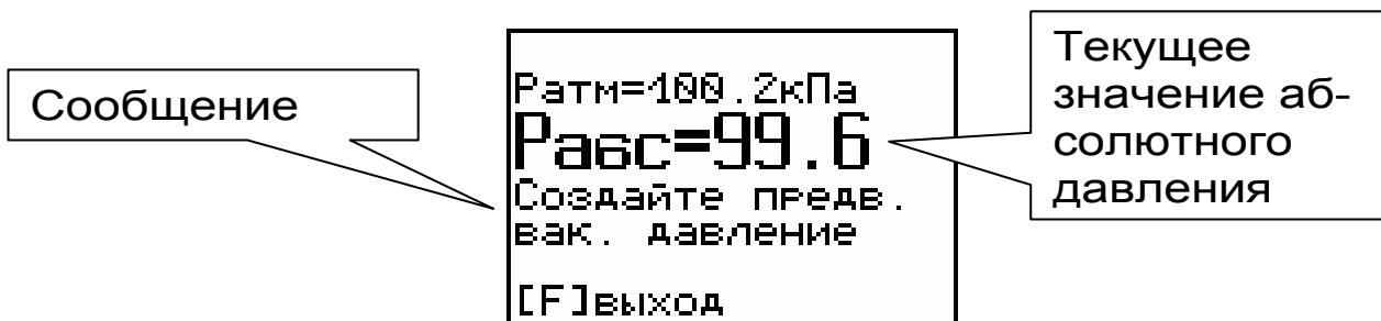
Для облегчения работы с прибором в режиме измерения на дисплей выводятся подсказки о порядке требуемых действий. Поэтому после активации этого режима оператору будет предложено создать в камере необходимое вакуумметрическое давление.
