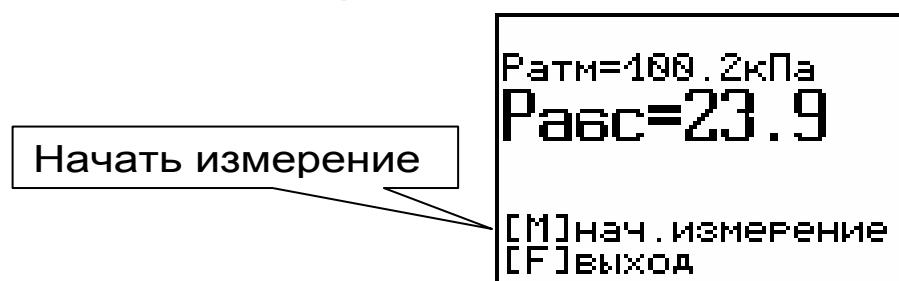
После нажатия клавиши **M** начнется регистрация процесса измерения давления, и прибор выдаст сообщение о необходимости «Открыть клапан». Одновременно с этим будет запущен таймер обратного отсчета времени, в течение которого кнопку 7 клапана 9 (рис. 1) надо нажать.
