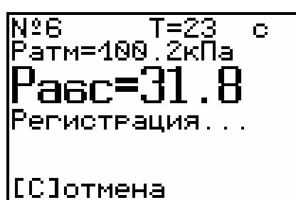
5.4.8. Дождаться окончания процесса измерения. Прибор автоматически вычислит сопротивление проникновению воздуха  $m$ , параметр воздухопроницаемости  $a$  и марку по водонепроницаемости  $W$ . Эта информация будет выведена на дисплей и сохранена в памяти прибора.
