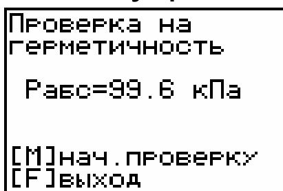
5.3.7. Подсоединить к штуцеру 10 вакуумный насос и создать в камере вакуумметрическое давление равное  $P_{вак} \geq 65$  кПа ( $P_{абс} \leq 35$  кПа).
