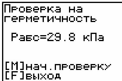
5.3.9. Нажать клавишу **M**, чтобы запустить автоматическую процедуру проверки герметичности. Прибор запомнит начальное давление в камере, и в течение часа будет самостоятельно отслеживать изменение давления  $\Delta P_{абс}$ .
