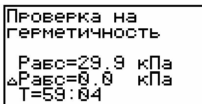
По окончании [C]отмена программы выдаст сообщение о герметичности прибора. Если давление измениться менее чем на 2 кПа, то прибор является герметичным и может поступить в эксплуатацию.
