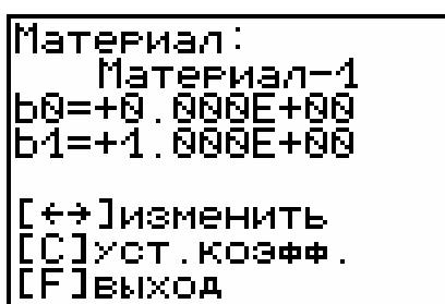
Этот пункт меню содержит один стандартный материал – бетон, для которого в программе прибора уже установлена корреляция между маркой по водонепроницаемости **W** и сопротивлением проникновению воздуха **m** (ГОСТ 12730.5-84 Приложение 4), и три программируемых (Материал-1, -2, -3).
