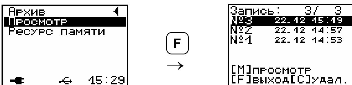
Войти в архив измерения можно с помощью клавиши **M**.
