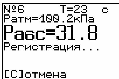
Процесс измерения можно принудительно прервать с помощью клавиши **C**.
