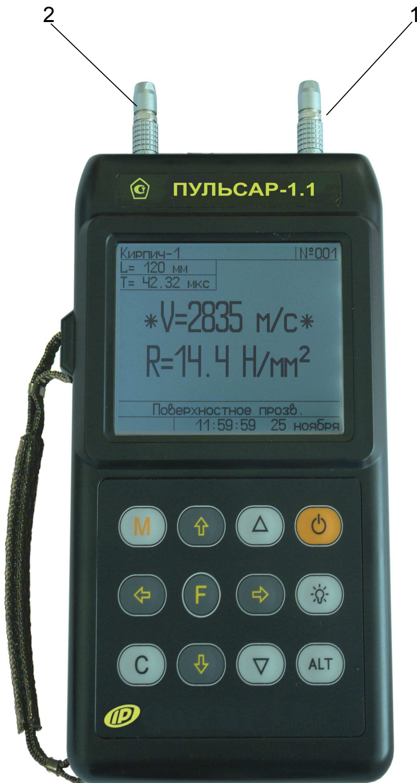
Рис. 3.2 Вид электронного блока: 1 – вход приемного преобразователя, 2 – выход излучающего преобразователя
