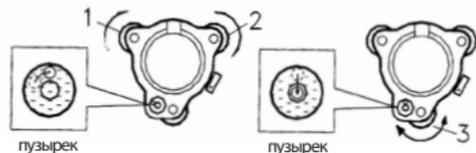
1.4. Выровняйте инструмент цилиндрическим уровнем
