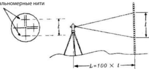
б. Выравнивайте прибор. Глядя в телескоп, замерьте длину между нитями на рейке.
