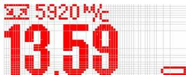
Четвертая стадия: батарея разряжена до напряжения 6,5V и менее. В этом случае на индикатор выводится на 5секунд сообщение о недопустимо низком напряжении на батарее:
