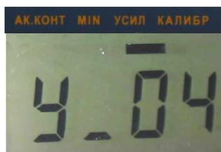
По окончании коррекции на индикаторе вновь отображается последнее измеренное значение толщины  $h$ .
