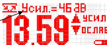
В данном исполнении толщиномер значение коэффициента усиления отображается в dB относительно уровня входного сигнала. И может быть изменено в диапазоне +20...+60dB с шагом 2dB.
