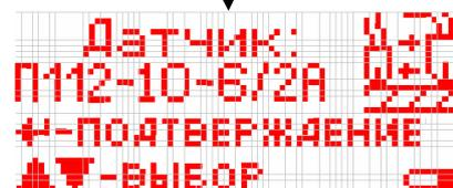
Задание типа подключенного преобразователя производится по нажатию кнопок  $\Delta$  и  $\nabla$ .
