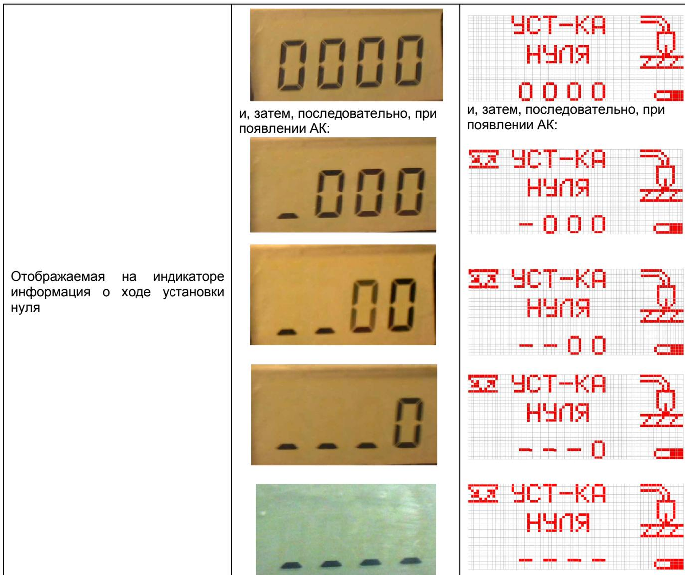
По результатам измерения производится компенсация влияния времени пробега ультразвуковых колебаний в линиях задержки на результат измерения толщины изделия  $h$ . На индикатор автоматически выводится измеренное значение ультразвуковой толщины юстировочной плитки для заданной скорости ультразвука (для скорости 5920 м/с показания  $6,00 \pm 0,05$  мм). При выполнении операций по данному пункту преобразователь должен быть постоянно прижат к юстировочной плитке.
