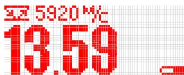
Третья стадия: батарея разряжена ниже критического уровня (напряжение менее 7,0V). Метрологические характеристики толщиномера при таком напряжении на батарее питания не могут быть гарантированы.
