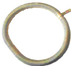
Предназначен для определения нарушений сплошности изоляционных покрытий труб диаметрами от 133 до 1420 мм в составе электроискрового дефектоскопа.
