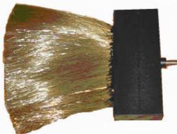
Предназначен для определения нарушений сплошности тонких и непрочных изоляционных покрытий в составе электроискрового дефектоскопа.
