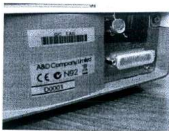
Рисунок 2 – Схема пломбировки весов от несанкционированного доступа
