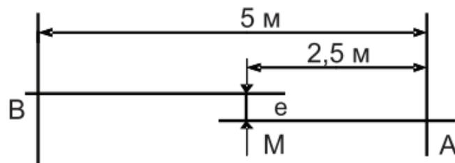
Повернуть лазерный построитель так, чтобы сместить луч приблизительно на 2,5м влево и проверить, чтобы горизонтальная линия находилась в пределах значения „точность” (см. характеристики) на той же высоте, что и нанесенная отметка, указанная лазерным крестом. Повторить эти же действия, смещая лазерный инструмент вправо. Внимание: ось вращения при проверке точности не смещайте.
