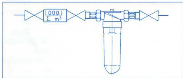
**Внимание!** Устанавливайте фильтр в отапливаемом помещении, не допускайте вредных воздействий (паров растворителей, мазута, моющих щелочных растворов, химических веществ любого вида, УФ-облучения и источников тепла свыше 65°C). Условный проход трубопровода должен совпадать с условным проходом фильтра.
