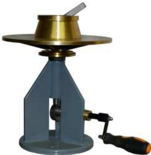
Используется для определения распыла цементного раствора и строительной извести.
