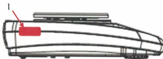
Рисунок 2 – Схема пломбировки от несанкционированного доступа, обозначение места нанесения разрушаемой наклейки (1 – пломба в виде разрушаемой наклейки).
