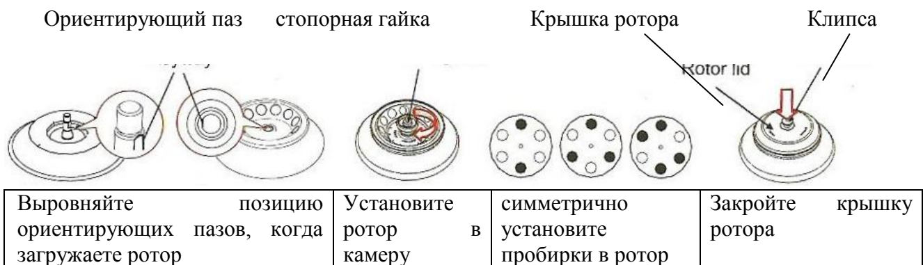
Изображение 8-2 Установка ротора
