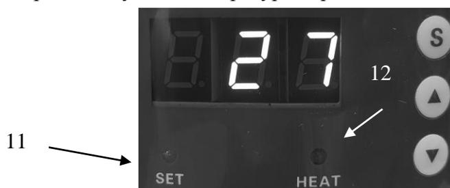
Для установки температуры нагрева нажмите кнопку «S». На дисплее загорится установленная температура нагрева. Индикатор «11» будет гореть зеленым цветом. При
