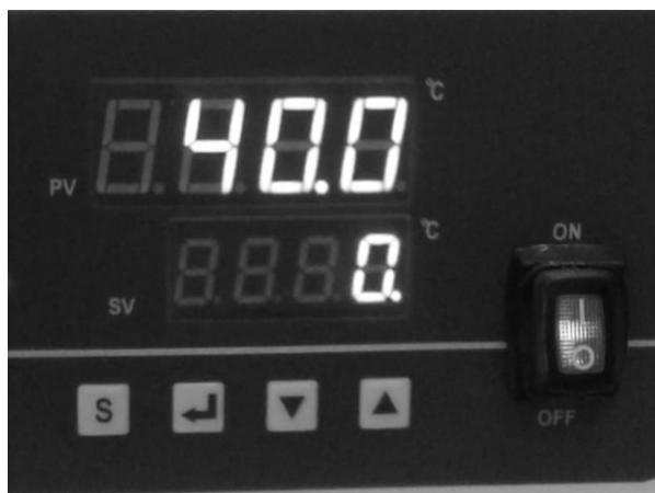
При включенном режиме таймера на контроллере горит индикатор «ALM»(исполнение **Вариант А**) или «TIM» (исполнение **Вариант Б**), на дисплее в разделе «PV» отображается текущая температура в резервуаре, в разделе «SV» время, прошедшее с начала работы после достижения заданной температуры.
