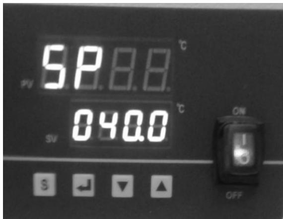
Для установки температуры нажмите кнопку «S». В разделе дисплея «PV» появится символ «SP». Эта надпись означает, что контроллер перешел в режим установки температуры. Далее при помощи кнопки «Влево» выберите тот разряд, значение которого необходимо изменить. Цифра в выбранном разряде начнет мигать, остальные цифры горят постоянно. После того, как выбрали нужную цифру, при помощи кнопок «Больше» и «Меньше» установите нужное значение. После того, как установили нужную
