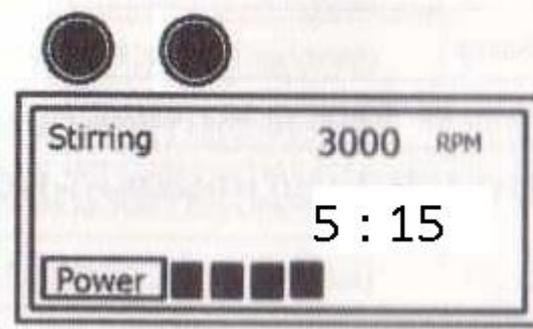
На рис. В режиме «Блокировка изменений» обе лампочки будут гореть. На дисплее вверху экрана отражается текущая скорость, в центре экрана – оставшееся время, в нижней части экрана – нагрузка на двигатель. (Внимание!!! Продолжительная работа с максимальной нагрузкой на двигатель может привести к порче прибора. Обязательно проверьте правильно ли собран и установлен прибор, соответствует ли вязкость образца характеристикам прибора).
