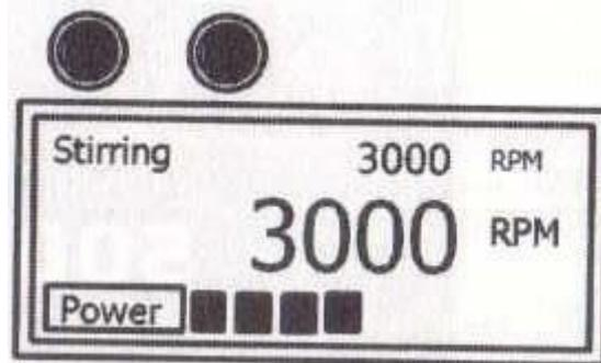
На рис. Состояние дисплей после запуска перемешивания. Красная лампочка мигает, Зеленая лампочка горит. На дисплее вверху экрана отражается установленная скорость, в центре экрана текущая скорость, в нижней части экрана – нагрузка на двигатель. (Внимание!!! Продолжительная работа с максимальной нагрузкой на двигатель может привести к порче прибора. Обязательно проверьте правильно ли собран и установлен прибор, соответствует ли вязкость образца характеристикам прибора).
