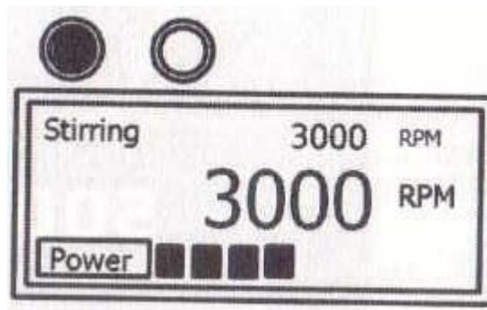
На рис. Состояние дисплей после запуска перемешивания. Красная лампочка мигает, Зеленая лампочка не горит. На дисплее вверху экрана отражается установленная скорость, в центре экрана текущая скорость, в нижней части экрана – нагрузка на двигатель. (Внимание!!! Продолжительная работа с максимальной нагрузкой на двигатель может привести к порче прибора. Обязательно проверьте правильно ли собран и установлен прибор, соответствует ли вязкость образца характеристикам прибора).
