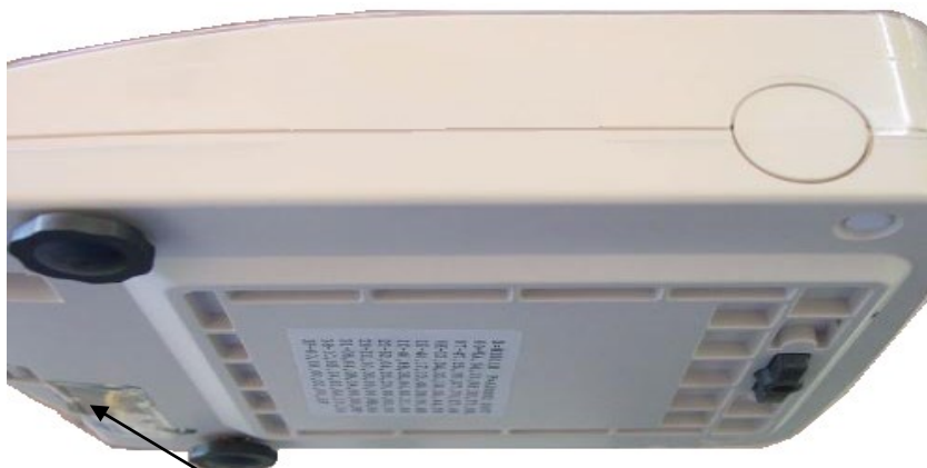
Место нанесения клейма в виде наклейки (переключатель юстировки)
