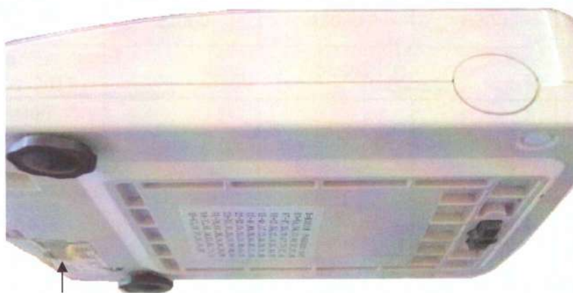
Место размещения пломбы (переключатель юстировки)
