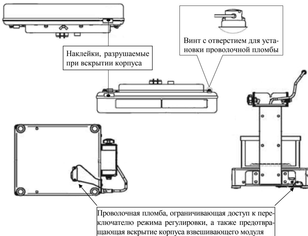
Рисунок 2 - Схема пломбировки от несанкционированного доступа
