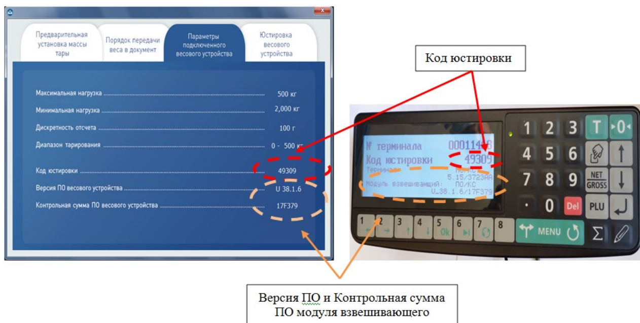
Рисунок 5 – Индикация кода юстировки, версии ПО и контрольной суммы ПО модуля взвешивающего: а – на мониторе компьютера или кассового аппарата, б – на терминале.
