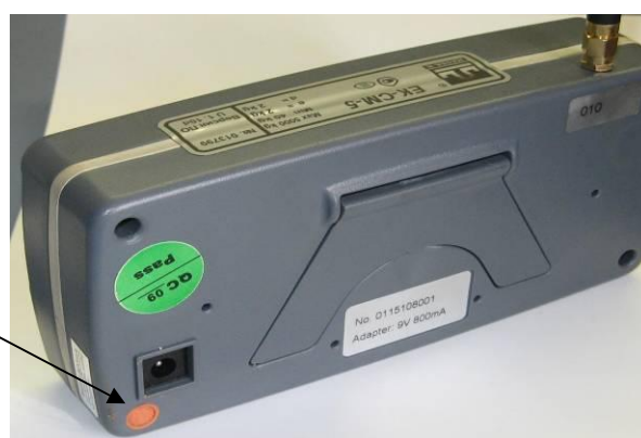
Рисунок 4 - Схема пломбировки от несанкционированного доступа, обозначение места нанесения знака поверки
