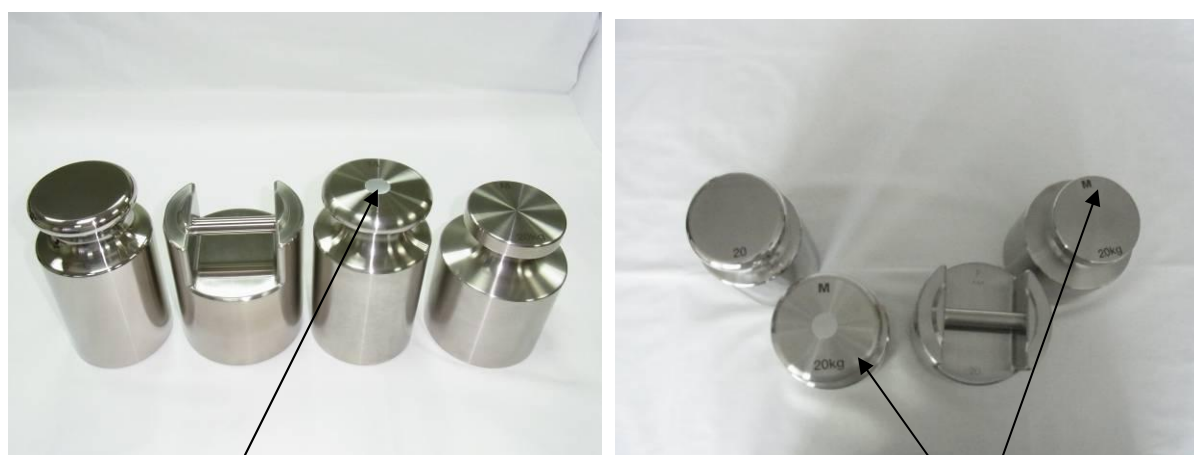
Рисунок 1 - Общий вид гирь от 1 г до 10 кг цилиндрических без головки и с головкой
