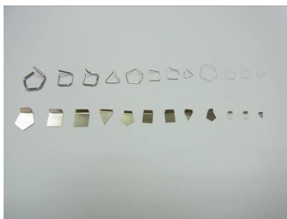
Рисунок 3 - Общий вид гирь миллиграммовых пластинчатых и проволочных
